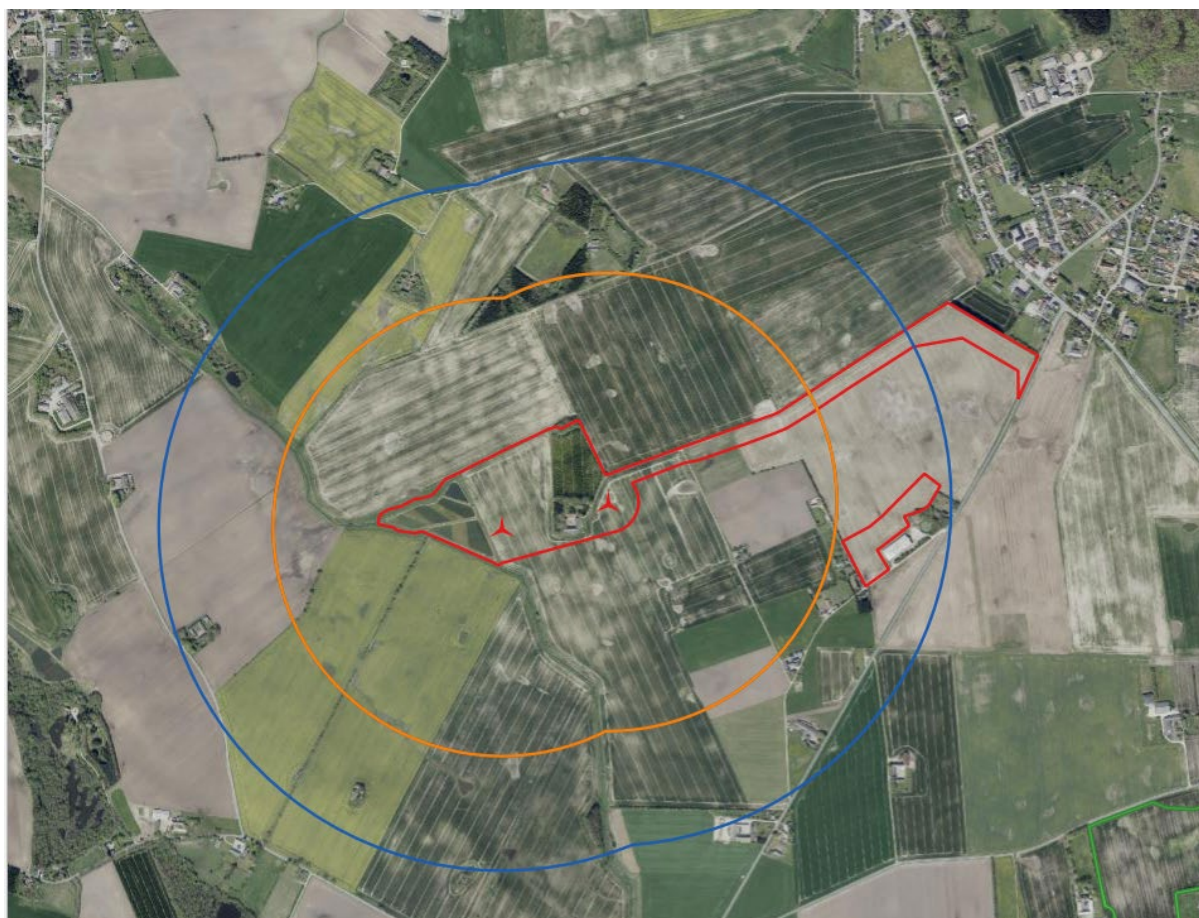
Figur 1–1. Projektområdet med placering af vindmøller, samt vejadgange. En bufferzone på 600m (orange streg) og 900m (blå streg) er markeret om de to møller.
